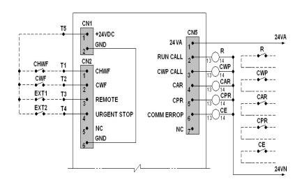
**Field Wiring Diagram**
